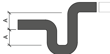
Figura 9 A > P + 10\text{mm} P = Presión o depresión (mmca) en zona de desagüe
