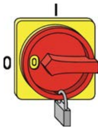
Fig. 5: Asegurar el interruptor principal
