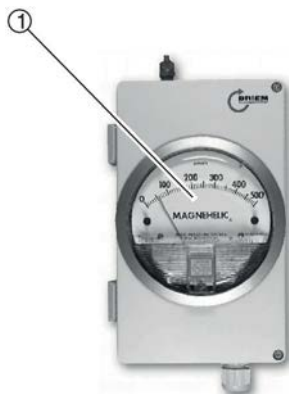
Fig. 49: Lectura del manómetro de presión diferencial
