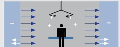
Flujo laminar de bajo índice de turbulencia
