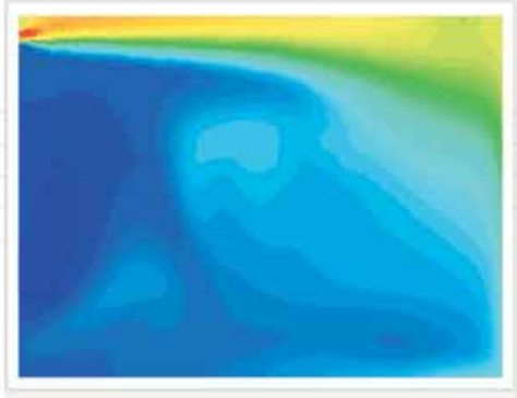
Detalle de la estructura del flujo a la salida de un inductor DID-E. Caracterización de la inducción generada.
