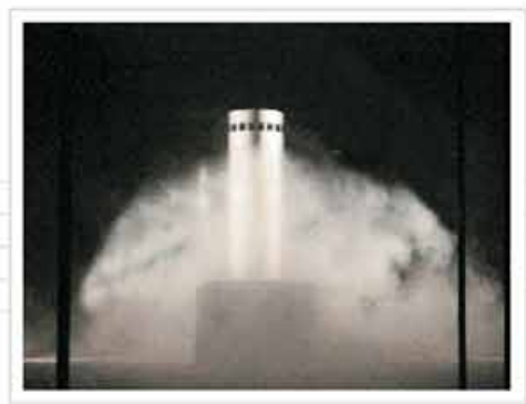
Visualización a escala real del entorno de un difusor de desplazamiento operando en refrigeración.
