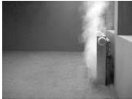
Imagen flujo de aire: Función. con calefac. y aire primario
