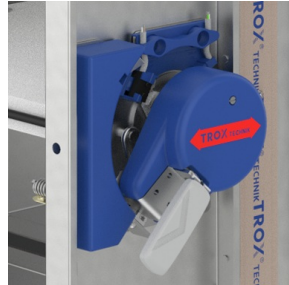
FK2-EU con fusible bimetálico para 72 °C o 95 °C
