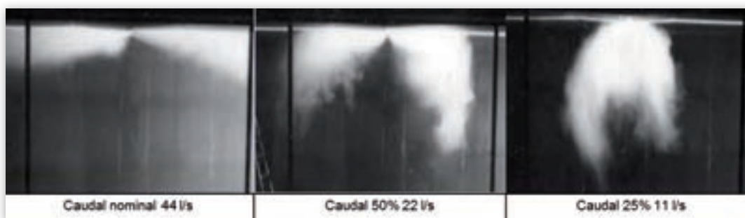
Imagen 3. Secuencia de disminución de caudal desde el 100% al 25% para un difusor lineal instalado en un sistema de caudal de aire variable.
