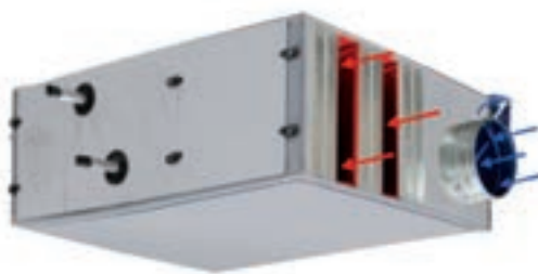
Imagen 8. Es recomendable contar con equipos perimetrales dotados de un ventilador auxiliar a caudal constante y una entrada de aire de ventilación variable en función de la calidad del aire.
