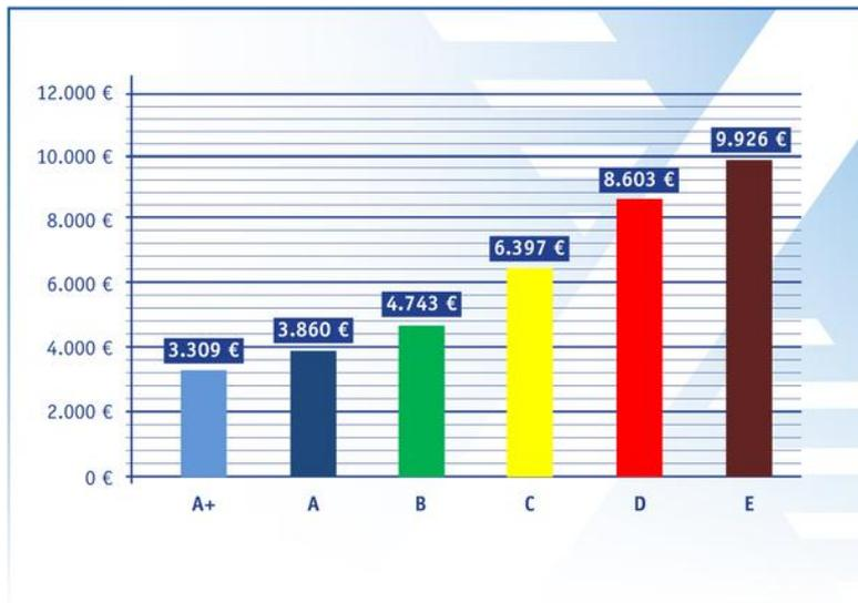
*Durante el periodo de tiempo de un año, un filtro de bolsa con una eficiencia filtrante F7 en cumplimiento con EN779 y con un caudal de aire de 100,000 m<sup>3</sup>/h, con una eficiencia energética clase D implica un coste de 8603.00 EUR. Sin embargo, un filtro con eficiencia energética clase A+ implica un coste de 3309.00 EUR. El reemplazo de filtros con eficiencia filtrante de clase D a A+, permite un ahorro anual de un 61% (o lo que es lo mismo 5294.00 EUR)*
