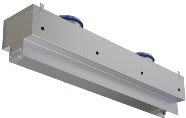
Plenum de inferior tamaño al difusor, disposición a la izquierda y con 2 bocas para entrada horizontal de aire
