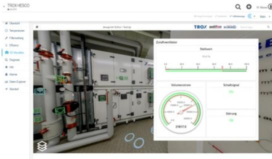
*3D Visualisierung - Einfache Zuordnung von Sensor- bzw. Aktorwerten an der Anlage*
