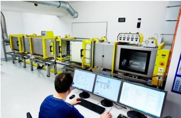
Banco de pruebas para ensayo de filtros
